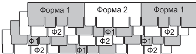
Рис. 5 Схема чередования гонтов гибкой битумной черепицы Döcke PIE коллекции Саппоро.
